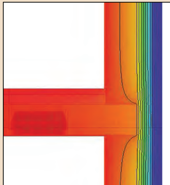
Esempio di ponte termico del particolare cordolo-trave-muratura.
